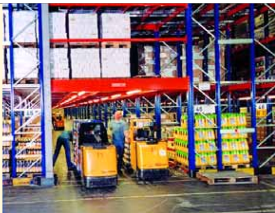
Raumgewinn: Kommissioniertunnel im umgerüsteten Edeka-Lager.
