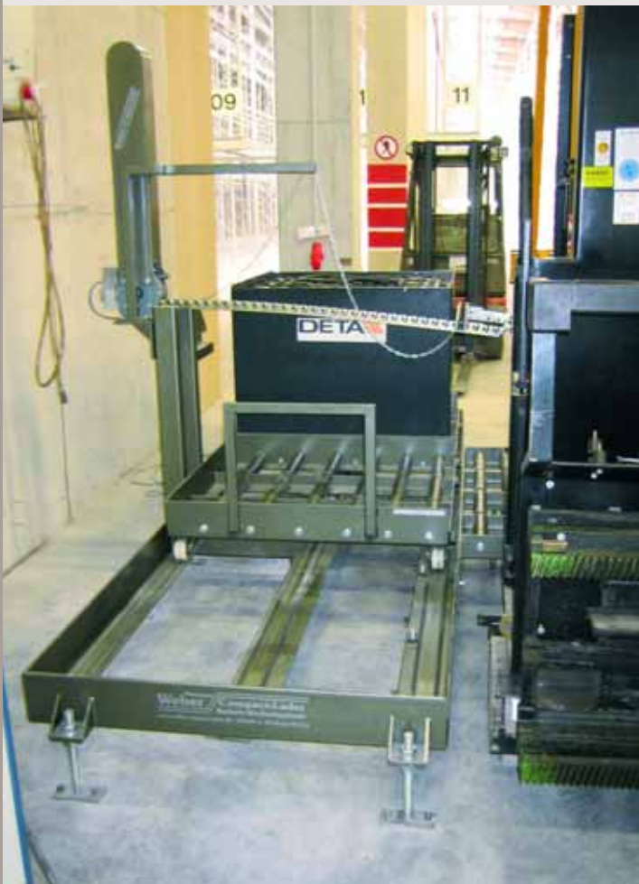
Im Wechsel zum Laden: Vielfach werden leere Akkus gewechselt und separat geladen.
