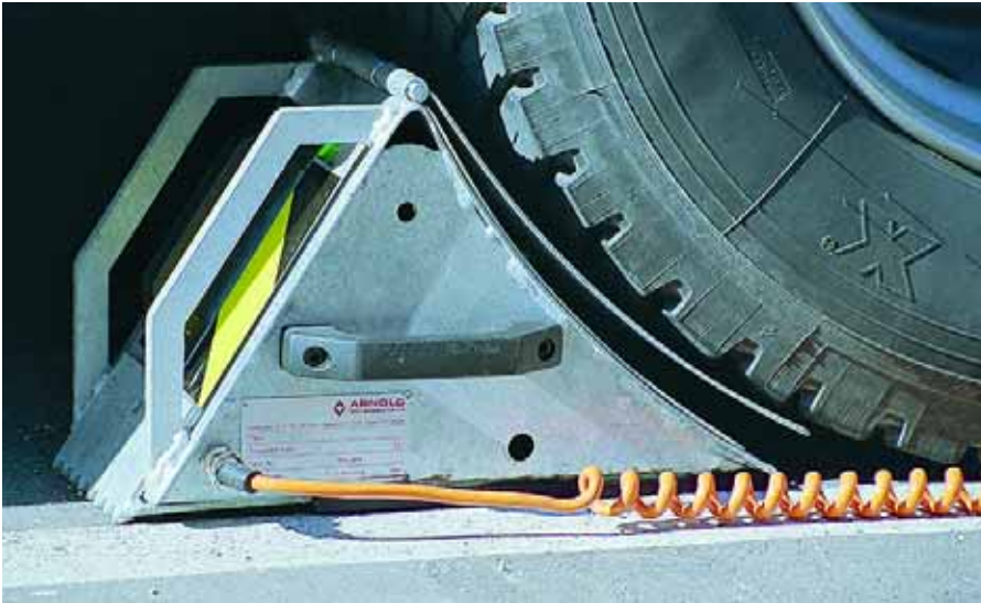
Weithin sichtbar verkeilt: Der Elektrokeil gibt das Verladen erst frei, wenn der Lkw ordnungsgemäß gesichert ist.
