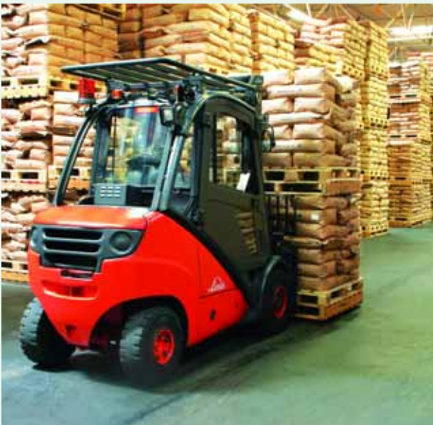
Ruß raus: Linde bietet für seine gesamte Dieselstapler-Reihe integrierte Rußpartikelfilter.
