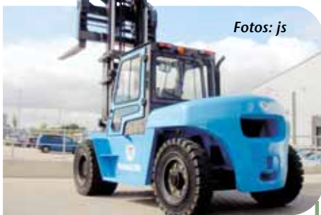
Schwerer Junge: Der zurzeit größte Dieselstapler aus dem Hause HanseLifter hebt 10 t. Das Programm umfasst Drei- und Vier-Rad-E-Stapler und Dieselstapler.
