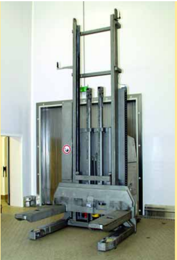
24-Stunden-Einsatz: Die Gabeln des MLR-Phoenix können 4,6 t tragen und erreichen Hubhöhen bis 3,80 m.
