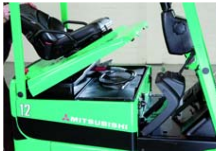
Rapid Access: Schneller Zugang zu allen wartungsrelevanten Teilen.
